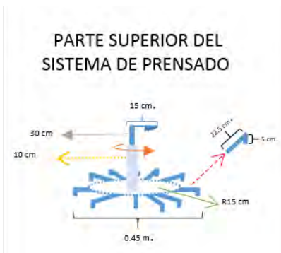
Fig. 6 La parte superior del sistema de prensado tiene como actividad la sujeción a presión del tambor, es importante mencionar que el afinado de una caja dependerá de que tan ajustado quede el tambor.
