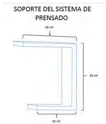
Fig. 8 El ajustador que simula esta figura será encargada de sujetar y prensar el tambor de manera adecuada, será el principal soporte donde se colocara el tambor y el sistema de prensado.
