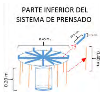
Fig. 7 Las barras de 0.40 m, son fundamentales para lograr una afinación adecuada ya que son las encargadas de realizar el sistema de jale para la piola.
