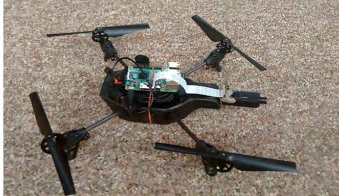
Figura 1. Raspberry Pi y cámara Picamera montada sobre AR.Drone 2.0.
