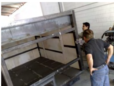
Imagen 2. Construcción de Horno Crematorio. Fuente: Empresa, Refractarios y Hornos Industriales.
