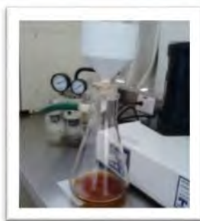
Figura 4. Filtrado a vacío
