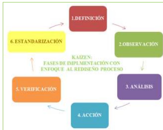
Figura 4. Fases generales de la aplicación de Kaizen para el rediseño y optimización de la línea de producción de diademas auriculares.
