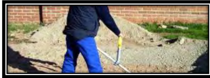
Figura 3. Adecuación de un mango en una herramienta para reducir lesiones en la espalda Fuente: Prevention World (Alberto Farreras Ramesal, Instituto de Biomecánica de Valencia) .
