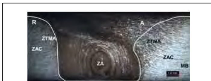
Figura 3. Zonas del cordón de soldadura obtenido por FSW. Se muestran ZAC, las ZTMA, la ZA y parte del material base (MB). En la ZAC se observan los llamados “anillos de cebolla” característicos de este tipo de uniones por FSW.
