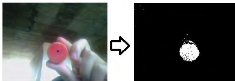
Figura 2. Detección de un objeto con la Picamera utilizando la tarjeta Raspberry .
