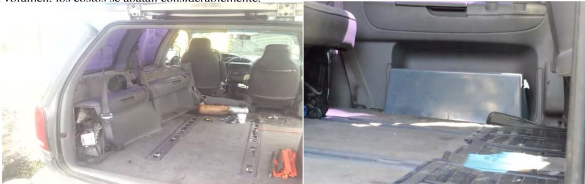
Fig.5.a) Ilustra el espacio para la unidad de potencia, la unidad ya colocada y puesta la guarda
