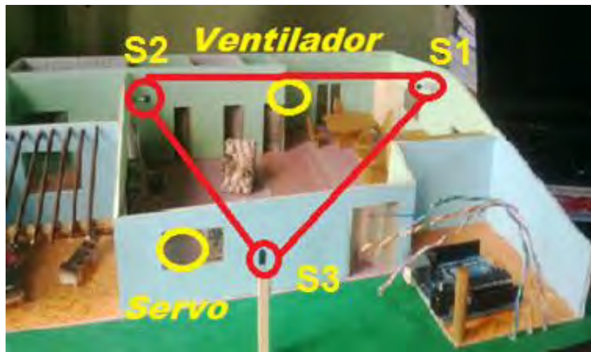
Figura 2. Posición de Sensores respecto a la instalación de Ventilador de Pruebas y Servo para automatización de Ventana.
