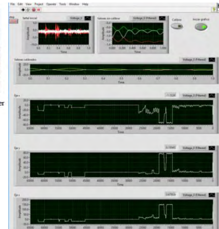
Figura 7 Interfaz de LabView para monitoreo del dinamómetro KISTLER 5010B.
