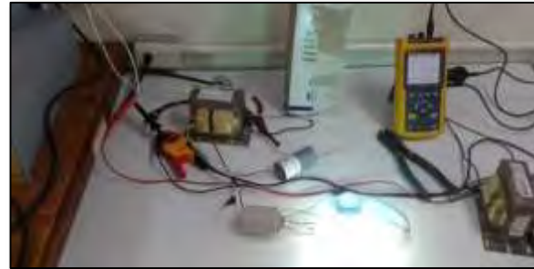
Figura 7. Medición en sitio de una lámpara de aditivo metálico (encendida parcialmente al instante de la fotografía)
