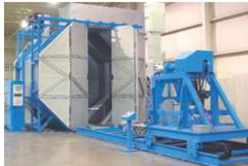
Figura 2. Horno de Rotomoldeo tipo *shuttle*.
