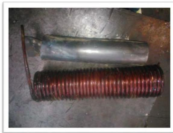
Figura 2. Bobina de inducción y Tubo de acero al carbono.
