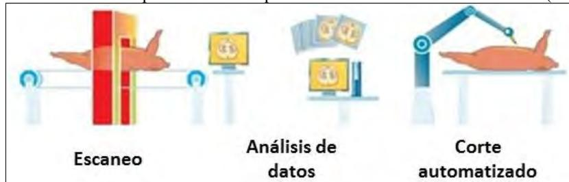
Figura 9. Sistema de TC en línea para la industria alimenticia. Fuente: Adaptada de De Chiffre et al. 2014.
