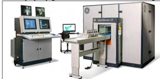
Figura 8. Sistema de TC en línea para la industria automotriz. Fuente: Brunke et al. 2013.
