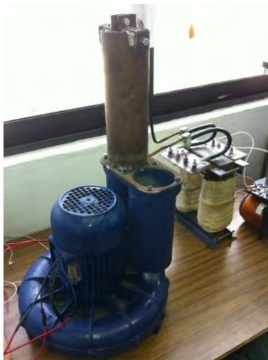
Figura 5. Prototipo del generador de aire por inducción.
