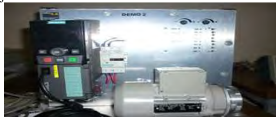
Figura 2. El sistema inversor de Siemens y el motor trifásico físicamente.
