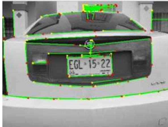
Figura 2. Detección de líneas de la parte trasera de un vehículo al aplicar la transformada de Hough.
