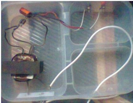
Figura 23: Fuente rectificadora de la cinta transportadora.
