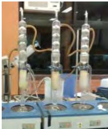
Figura 3 Equipo Soxhlet utilizado en la determinación de grasas.
