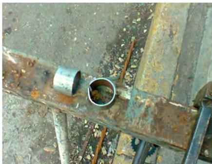
Figura 5: Tubo de mufa modificado para la creación de chumacera
