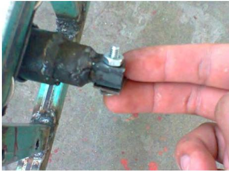
Figura 13: Cruceta en eje de la cinta transportadora.
