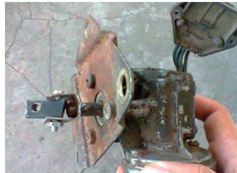
Figura 12: Cruceta en eje de motor.
