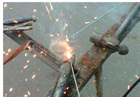
Figura 6 Tubo de mufa soldado para la creación de la chumacera
