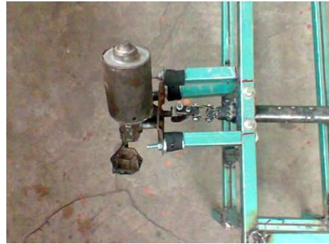
Figura 14: Motor acoplado al eje de la cinta transportadora.
