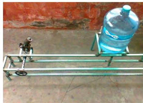
Figura 16: Estructura de la cinta transportadora.
