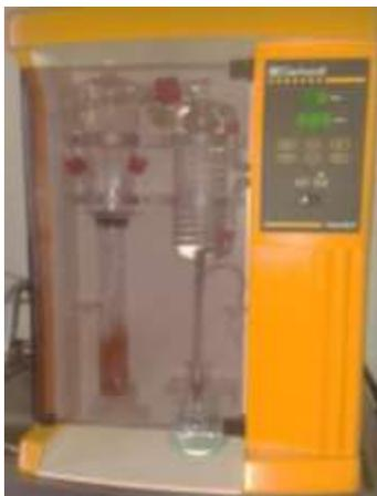
Figura 4 Equipo Micro Kjeldahl utilizado en la determinación de proteínas.
