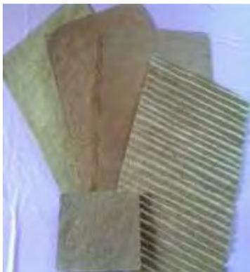
Figura 5. Pliegos de papel a base de pseudotallo de plátano elaborados a nivel planta piloto
