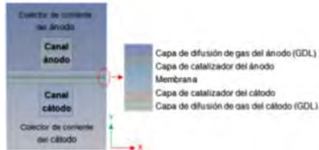
Figura 1. Componentes de una PEMFC considerando una geometría plana simple.
