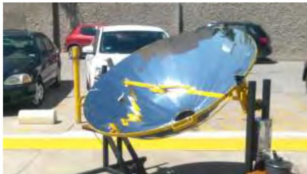
**Figura 4 Cocina solar disco parabólico ITLaguna**
