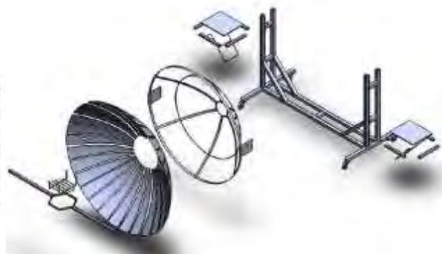
Figura 16 Vista explosionada de la cocina solar
