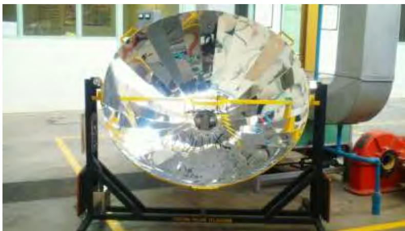
**Figura 1** Concentrador solar de disco parabólico para cocción de alimentos ITLaguna-2015
