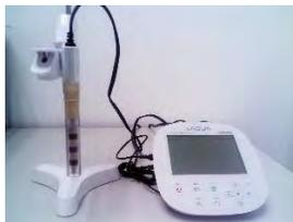
Figura 2. Conductímetro *HORIBA* modelo *F-74BW-G* con una constante de celda de 1 cm<sup>-1</sup>.
