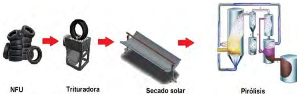
Figura 1. Proceso de pirólisis de llantas de desecho para la obtención de líquidos combustibles.
