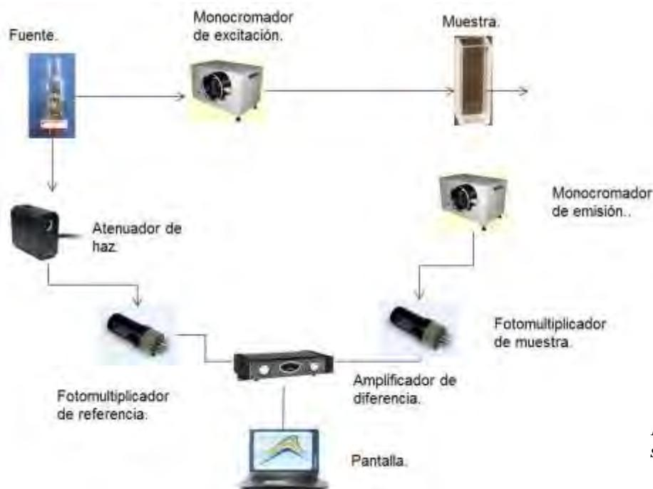
**Figura 2. Componentes del sistema de evaluación.**
