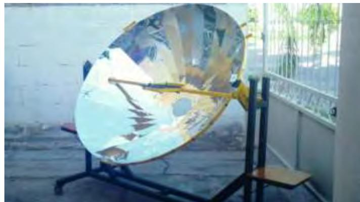
**Figura 8 Prototipo concentrador solar de disco parabólico**
