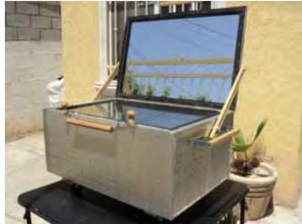
**Figura 3 Horno solar con espejo**
