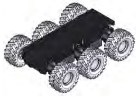
Figura 2. Estructura WildThumper 6WD.
