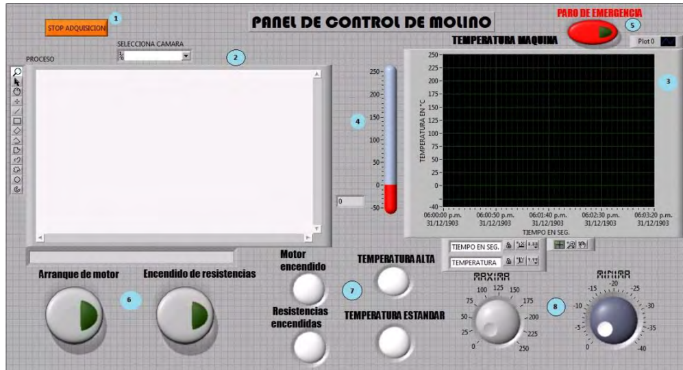
Figura 3. Panel de control de proceso de molino del Tetra Pak
