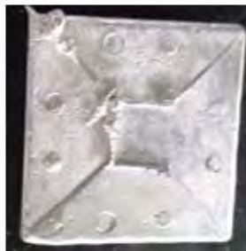
Imagen 5. Fotografía de aluminio fundido y vaciado en molde de cubo.
