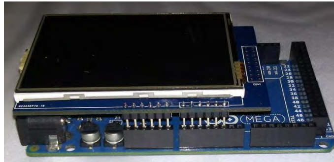
Figura 4. Ensamble de arduino con la pantalla touch.
