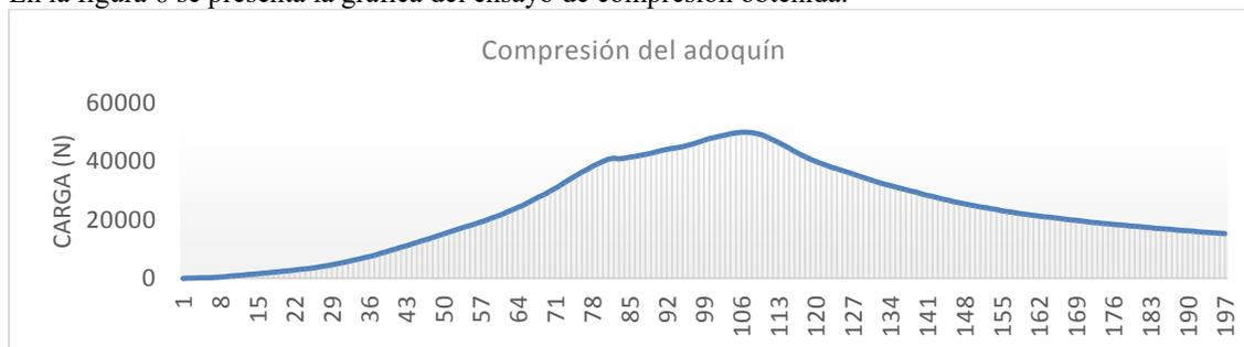
Figura 6. Gráfica del ensayo de compresión del adoquín.
