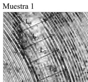
Figura 3.- Identificación del ancho de huella de las muestras del acero 5%Cr
