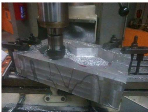
Figura 3. Maquinado del molde de inyección para el adoquín.
