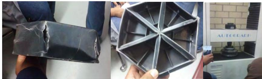
Figura 5. Ensayo de compresión del adoquín.
