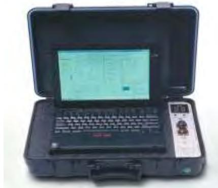
Figura 1. Analizador de pozo.
