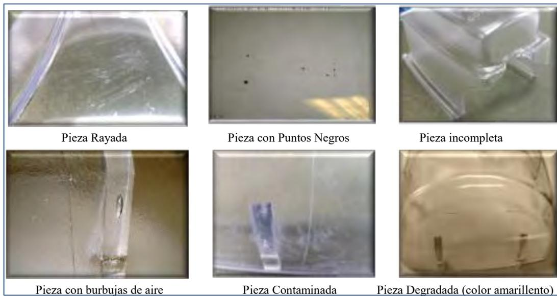
Figura 1.5 Defectos de piezas moldeadas en el área de moldeo. Fuente propia.
