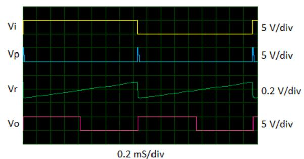
Figura 6 Formas de onda para  $f= 300 \text{ Hz}$
