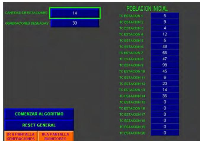
Figura 4. HMI de AG implementado en RS Logix 5000
