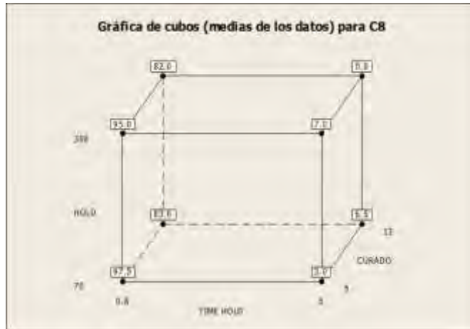
Figura 4. Gráfica de cubo de niveles óptimos con la característica mayor es mejor.
