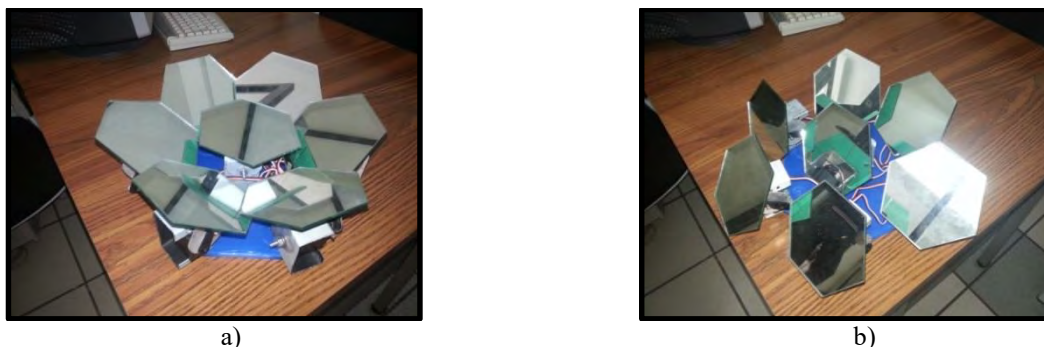
Fig. 10. Prototipo concentrador solar modular de siete espejos. a) concentrador parabólico, b) seguidores solares independientes
