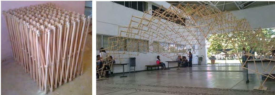
**Figura.-14, 15.** La verificación deja pautas para el mejoramiento de la conexión y alternativas para la utilización de otros materiales más resistentes y ligeros. Fuente: Miguel Diaz, Ramiro Tello. Año 2014.
