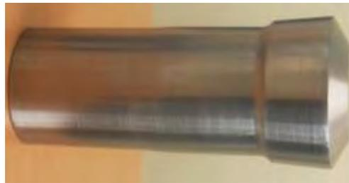
Figura 5. Cuerpo de la broca una vez finalizada la fabricación
