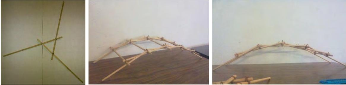
**Figura.-8, 9, 10.** Modelos de Experimentación, las cargas que genera este modelo son transferidas a cada miembro.
