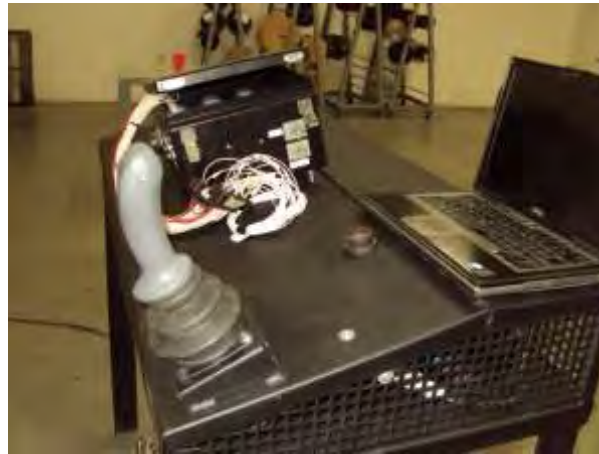
Fig. 4 Imagen de Panel de pruebas, simulación de pruebas a una caja de control.
