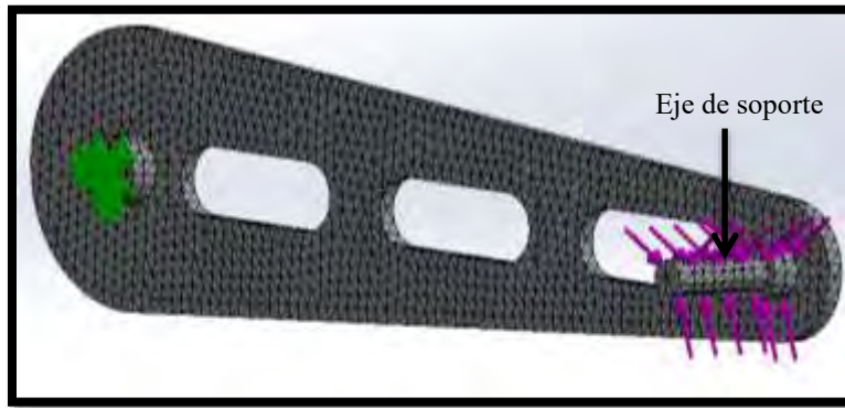
Figura 6. Representación de la zona mallado, sujeciones y dirección de fuerzas en el brazo de posición.
