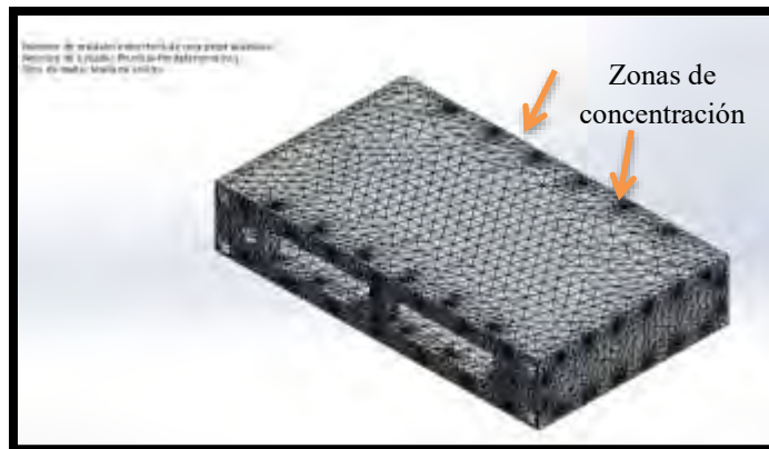
Figura 4. Representación de las zonas de concentración de esfuerzos.
