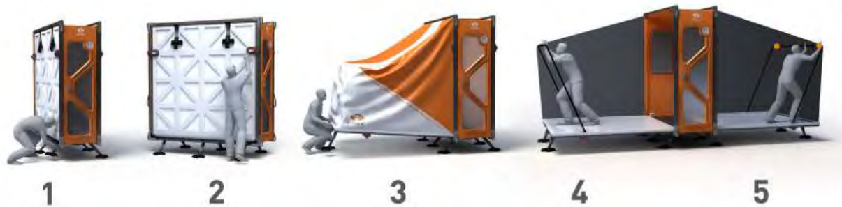
Fig. 7. 1. Se despliegan las bases centrales y se sujetan al suelo. 2. Se quitan los bloqueos laterales. 3. Se despliega la cubierta lateral y se ajustan las bases. 4. levantar travesaño principal y 5. Ajustar travesaño para tensar la cubierta.
