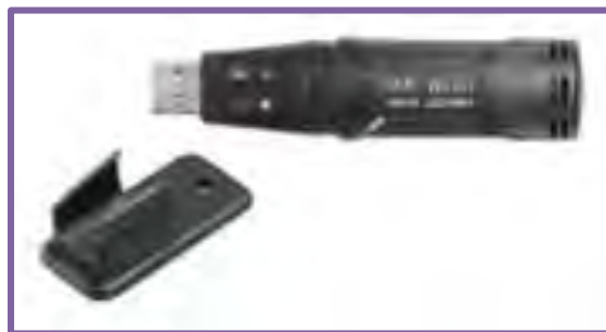
Figura 2.- Termómetro datalogger CEM DT-171 utilizado en la investigación.
