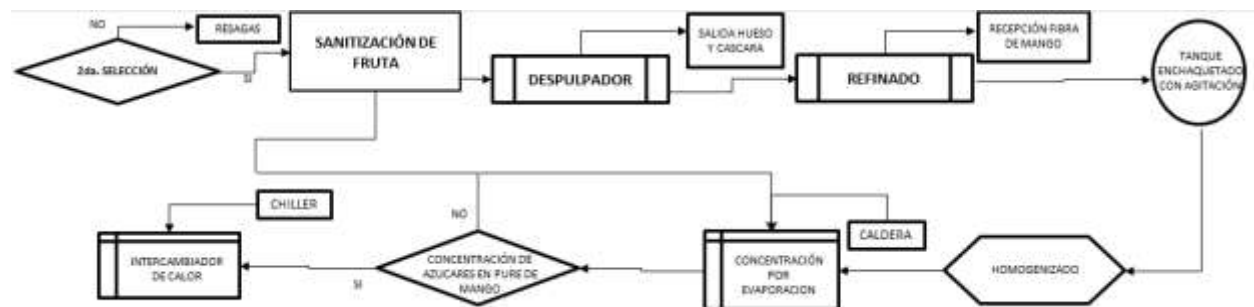
Figura 3. Proceso de producción de pulpa. Fuente: Elaboración propia.
