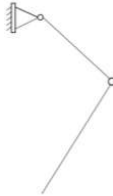
Figura 3. Mecanismo articulado de 2 barras. Fuente: Elaboración propia.
