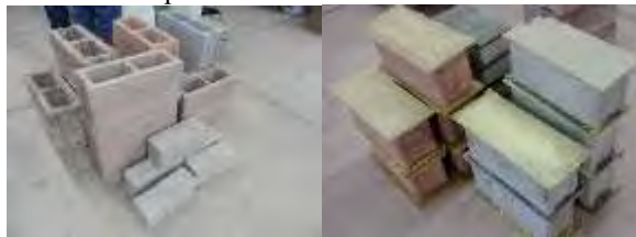
Serie fotográfica 2 Fotografías 5, 6 de izquierda a derecha. Clasificación y etiquetado de especímenes y la colocación de capas de azufre para pruebas de compresión. Archivo personal J. Alberto Méndez
