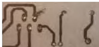
Figura 6 Decapado químico en una tarjeta
