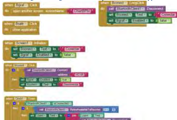
Figura 8. Programación a bloques del App en App Inventor.
