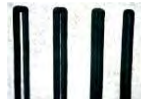
Figura 17 Definición del trazado de una punta de 90° (de izquierda a derecha) 0.9mm, 0.6mm, 0.5mm, 0.4mm
