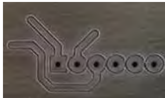
Figura 3 Placa delineada solo con grabador
