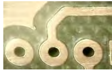
Figura 8 Vista en microscopio de las pistas hechas por método mecánico
