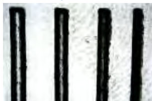
Figura 15 Definición del trazado de una punta de 30°, (de izquierda a derecha) 0.5mm, 0.4mm, 0.3mm, 0.2mm
