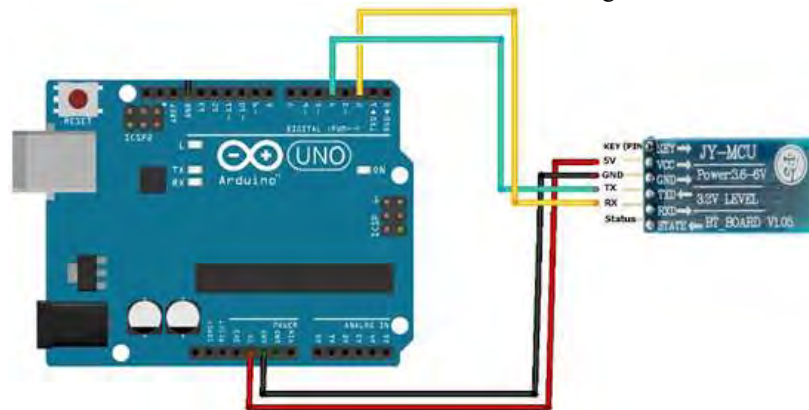
Figura 6. Conexión de Arduino uno a módulo HC06.
