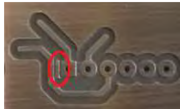
Figura 4 Grabado incluyendo decapado primario
