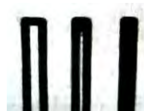
Figura 16 Definición del trazado de una punta de 45° (de izquierda a derecha) 0.9mm, 0.6mm, 0.5mm
