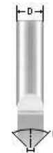
Figura 9 Forma general de una punta en V. 'D' es el diámetro de la punta, 'A' el ángulo de apertura
