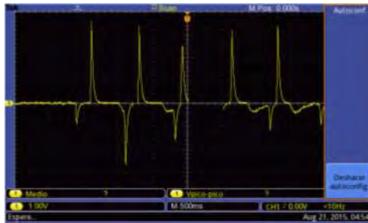
Figura 5. Visualización de la señal de ritmo cardiaco en el osciloscopio
