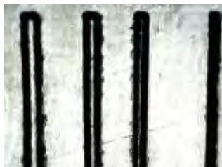
Figura 14 Definición del trazado de una punta V de 20°, (de izquierda a derecha) 0.5mm, 0.4mm, 0.3mm, 0.2mm
