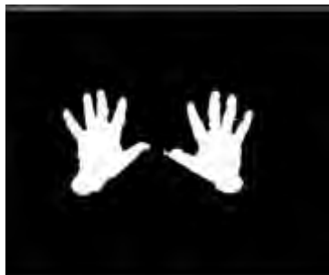
Figura 2. Resultado de aplicar el proceso de segmentación a la imagen para extraer las manos. Los puntos válidos se representan en blanco y los puntos inválidos en negro.
