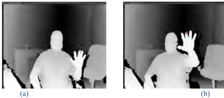
Figura 1. (a) Ejemplifica la posición que se asume que tomará el usuario en relación al sensor Kinect. (b) Se muestra el punto más cercano al sensor que, en este caso, corresponde al dedo medio de la mano del usuario.
