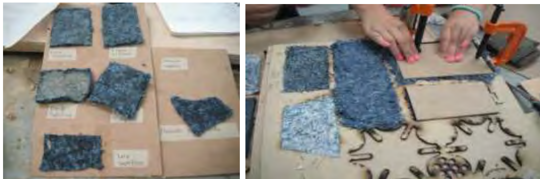
Figura 3. Preparación de muestras de 6mm de grosor con diferentes aglutinantes, empleando moldes de madera.
