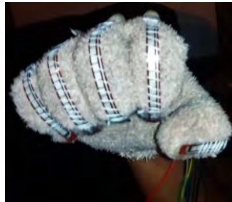
Figura 1. Aspecto físico del ensamble de los sensores flexibles al guante.
