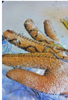
Figura 2. Interruptores de contacto colocados en guante.
