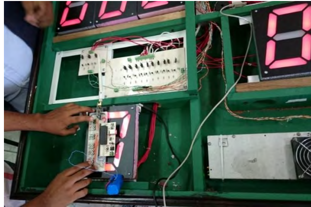
Figura 4. Tarjeta de potencia para alimentar a los displays.
