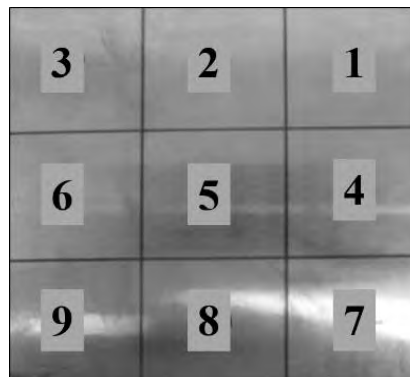
Figura 1. Esquema de los cortes realizados en la sección transversal de la palanquilla.
