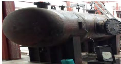
Fig.5 Prueba hidrostática.
