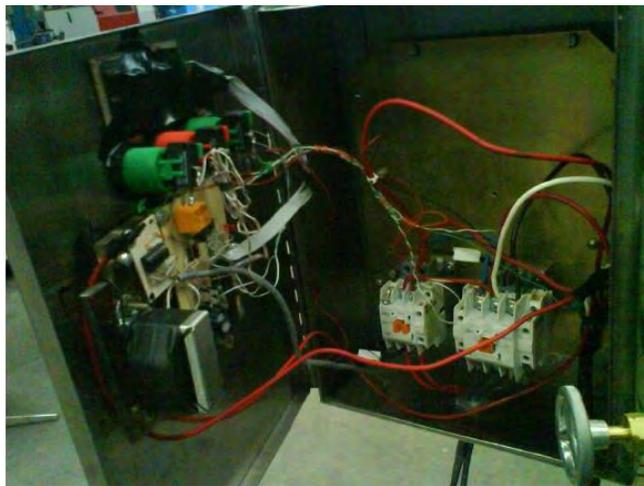
Figura 6. Control instalado en su gabinete y botonera.
