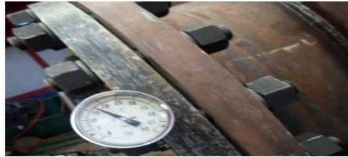
Fig.7 Prueba hidrostática de la entrada hombre.
