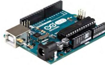
Figura 2. Tarjeta Arduino Uno.
