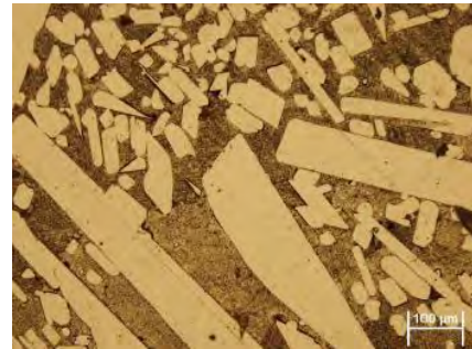
Figura 2. Estructura compuesta por partículas intermetálicas de Fe / Zn
