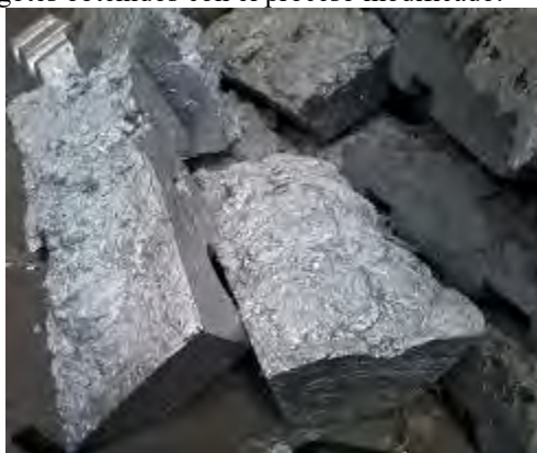
Figura 2. Dross de Zinc contaminado con hierro
