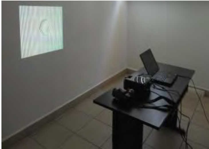
Fig. 4 Proyección de la rejilla sobre el objeto a digitalizar.
