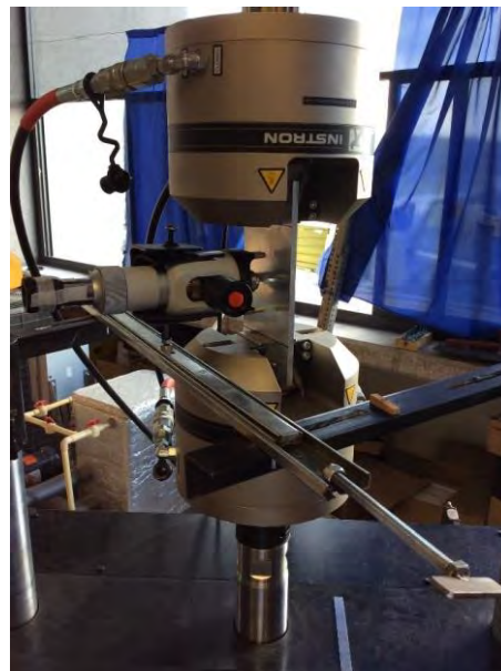
Figura 4. Ensayo de crecimiento de grieta por fatiga
