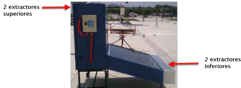
Figura 3. Posición de los Extractores (Inferior y Superior).
