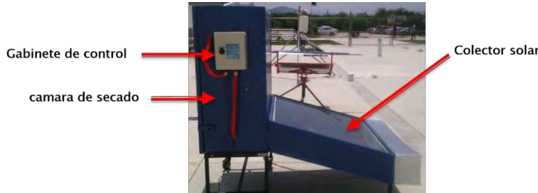
Figura 5. Colector solar, Gabinete de control y cámara de secado.
