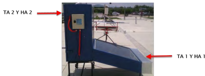
Figura 4. Posición de los Extractores (Inferior y Superior).
