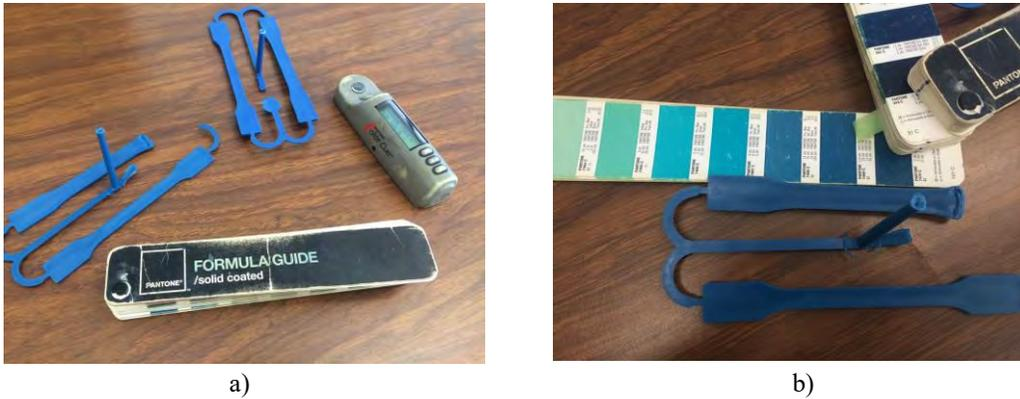
Figura 2. a) Se muestran las probetas obtenidas en la inyectora con distinto color, el colorímetro marca Pantone y la guía de colores Pantone.
