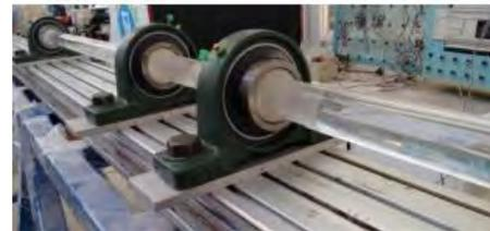
Figura 15. Montaje de los soportes y las barras sobre la base.
