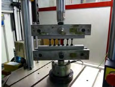
**Figura 3 Prueba para estimación de vida a fatiga**
