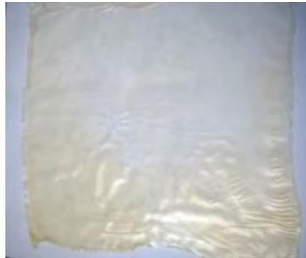
Figura 7. Película con 62.5% de glicerol y 1.28 ml de nanoemulsión.
