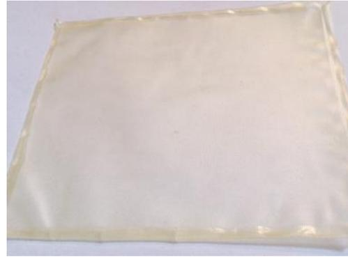
Figura 9. Película con nanoemulsión de xoconostle con 37.5% de glicerol, 12.5% de WPI y 0.2% de nanoemulsión.
