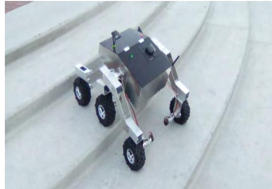
Figura 7. Robot móvil subiendo escaleras.
