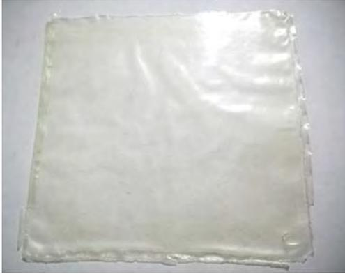
Figura 8. Película con nanoemulsión de xoconostle con 37.5% de glicerol, 12.5% gr de WPI y 0.2% de nanoemulsión.
