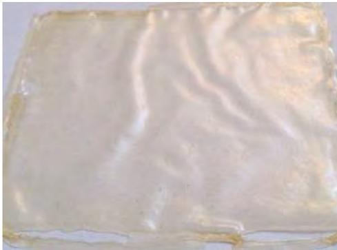
Figura 6. Película con 50% de glicerol y 1.28 ml de nanoemulsión.
