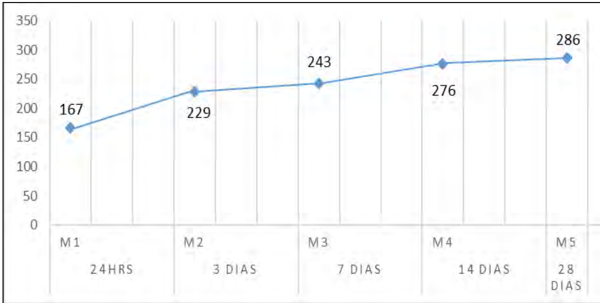
Figura 1. Resistencia obtenida de la mezcla finalmente diseñada con cubos.
