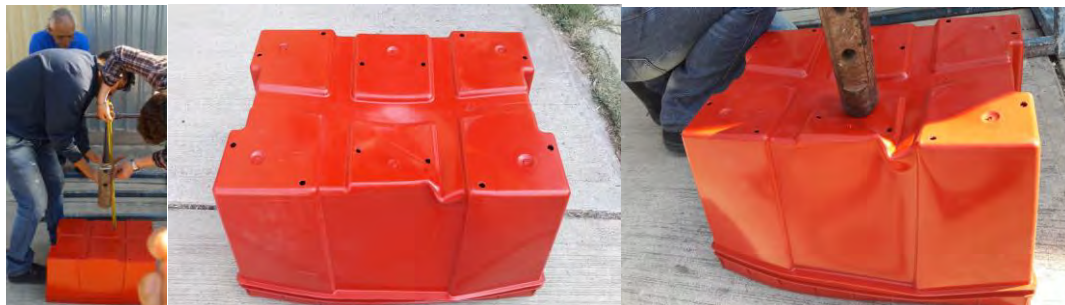
Figura 3.- Pruebas destructivas manuales.
