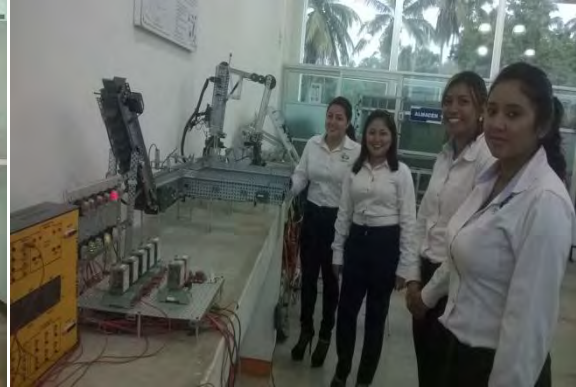
Figura 4 Sistema de entrenamiento de PLC mediante bandas transportadoras.
