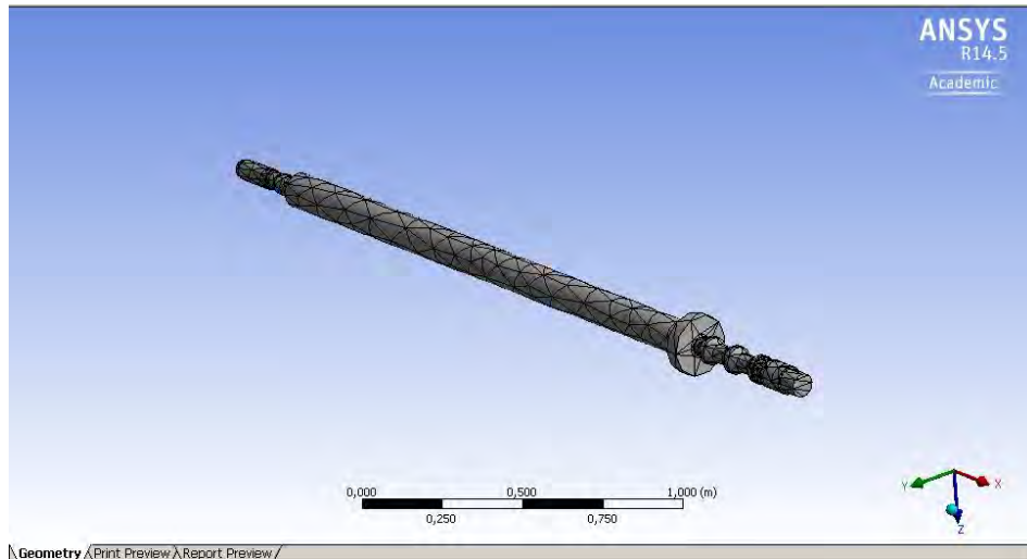
Figura 3. En la imagen del lado derecho, se aprecia el mallado aplicado a la pieza con un refinamiento de nodos en la zona de roscado.
