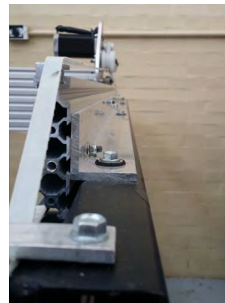
Figura 6.- Armado de estructura, ángulo de aluminio y perfil V- Slot
