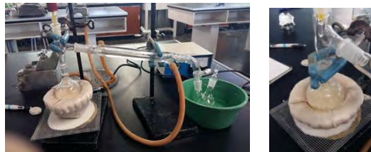
Figura 10.- Destilación del fermentado para la obtención de etanol.
