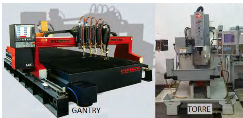
Figura 2. Arquitectura Gantry vs Torre
