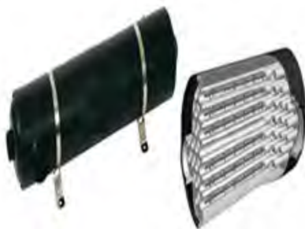
Figura 1. Modelo físico del intercambiador de calor carcasa y tubos.
