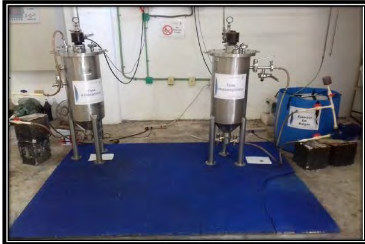
Fig. 1 Sistema de digestión anaerobia en fases
