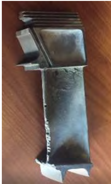
Figura 1. Alabe de Turbina metal base Inconel 739.
