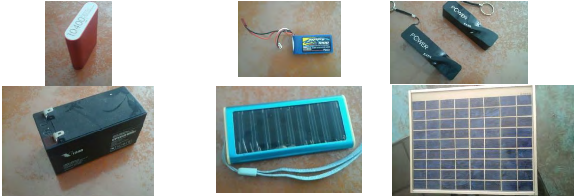
12. Pilas recargables usadas durante las pruebas, celda solar con pila LiPo integrada y la celda solar de 20v, 30w
