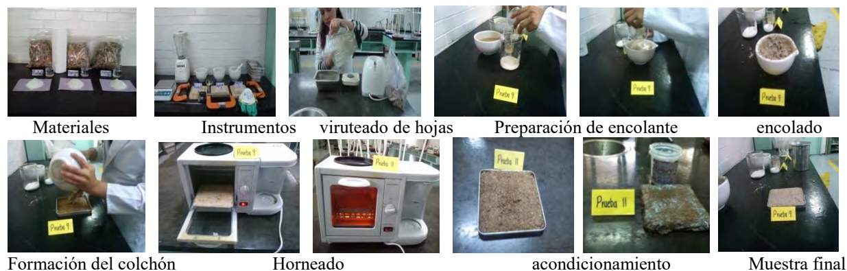
Fig.3 Secuencia de proceso documentado de elaboración de aglomerado con Linum usitatissimum PRUEBA 9 Fotografías: Laura Lizama
