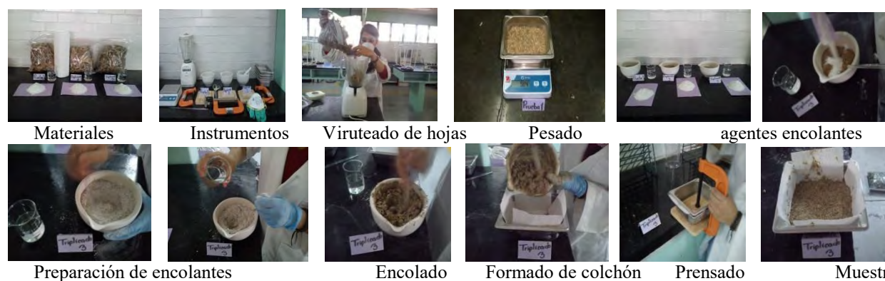
Fig.1 Secuencia de fotografías de proceso documentado de elaboración de aglomerado con Sulfato de calcio TRIPLICADO 3 (de prueba 4)
