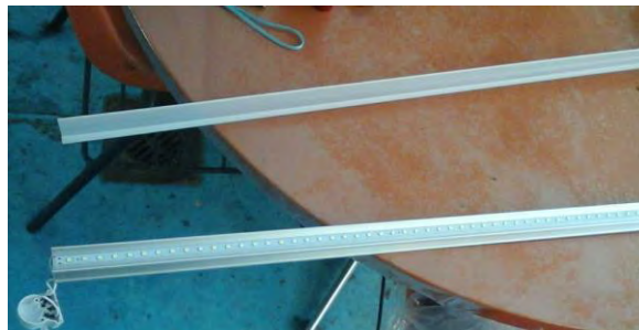
15. Lámpara de leds con base usada como estructura para el prototipo
