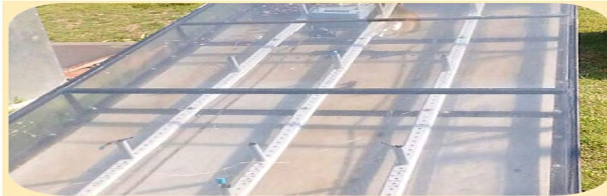
Figura 1: Deshidratador solar con 6 sensores de temperatura y 5 de humedad.
