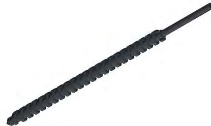
**Ilustración 5 Modelo (CAD) Husillo conductor.**
