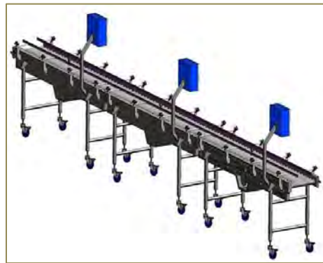
Figura 9 Ensamble lineal de los 3 módulos que conforman el transportador modular.
