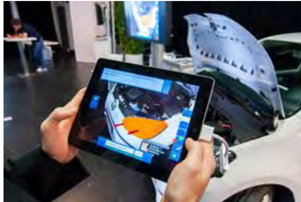
Fig. 2. Aplicación de Realidad Aumentada para servicio y mantenimiento. Fuente: Metaio Inc. (2014)
