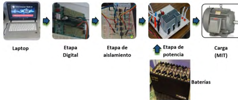
Figura 2. Diagrama a bloques de las etapas del sistema para la MIT.
