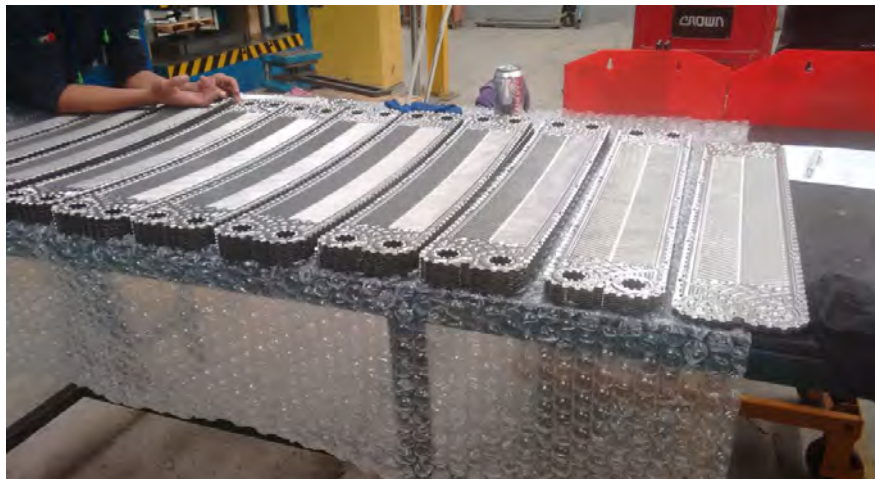
Figura 9 Primer lote prototipo fabricado de placas de intercambiador de calor.
