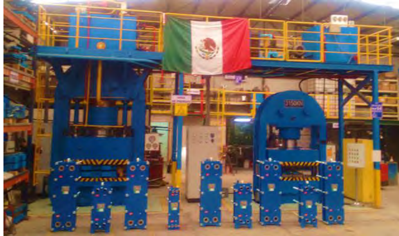
Figura 1 Prensa 3000T y Prensa 315T con intercambiadores de calor terminados al frente.
