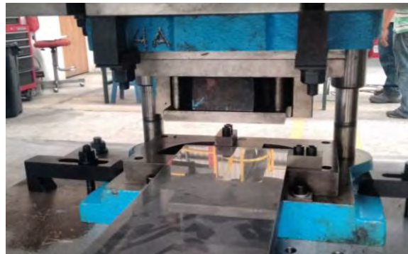
Figura 6 Placa en blanco en troquel de redondeo en prensa 315T
