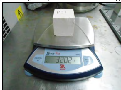
a) Pesado de la probeta seca P11 b) Pesado de la probeta saturada P31
