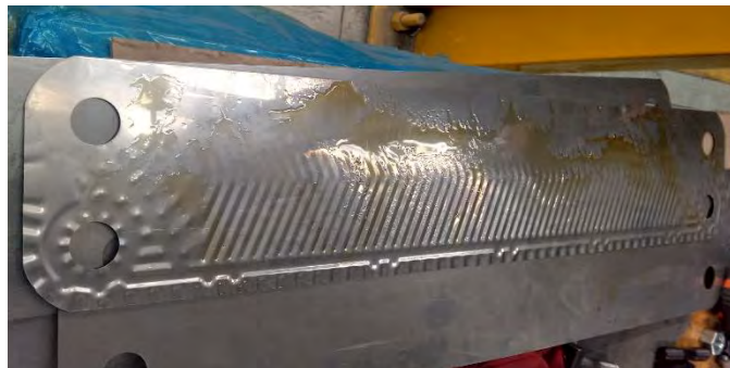
Figura 5 Placa con conformado defectuoso
