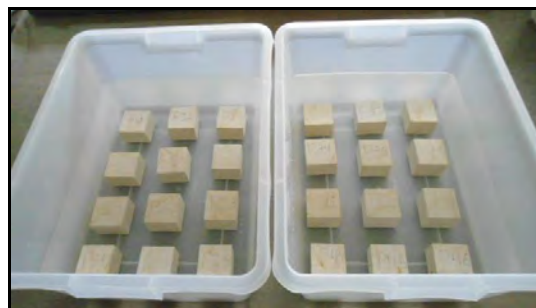
a) Secado de las 24 probetas en horno de secado b) Saturado de las 24 probetas en agua destilada
