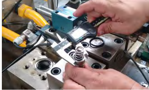
Figura 7 Comprobación de diámetro de pistón, junta tórica defectuosa al fondo en prensa 315T.
