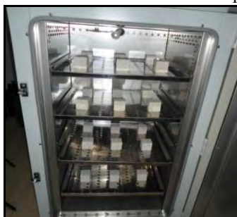
a) Secado de las 24 probetas en horno de secado b) Saturado de las 24 probetas en agua destilada
