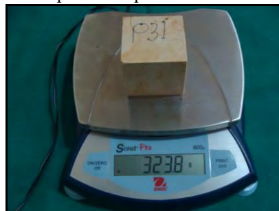
a) Pesado de la probeta seca P11 b) Pesado de la probeta saturada P31
