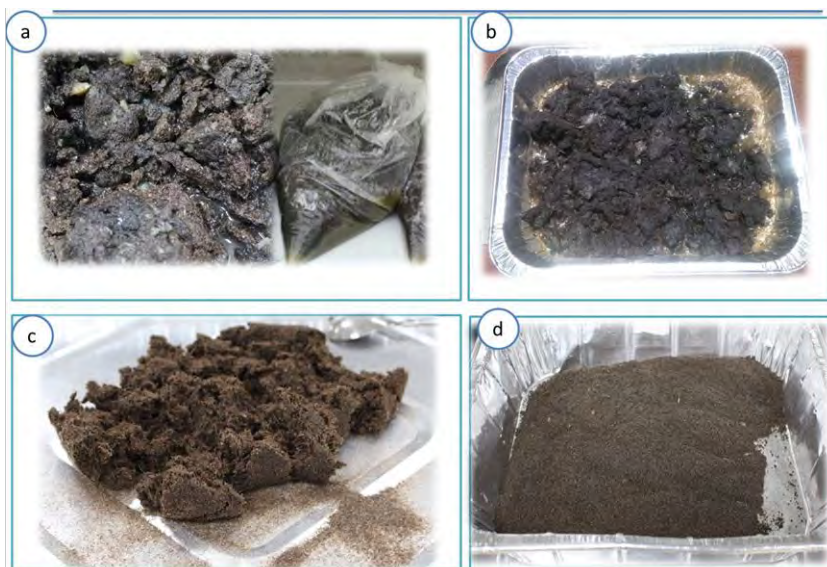
Figura 1. Imágenes de muestras del pelo de desecho en diferentes etapas del proceso de acondicionamiento: (a) recolectado en curtiduría; (b) antes del acondicionamiento; (c) después del lavado/molienda y; (d) después del acondicionamiento.
