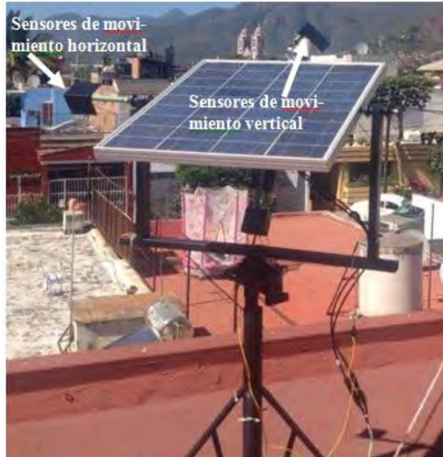
Figura 3. Sensores para el movimiento vertical y horizontal del seguidor solar.
