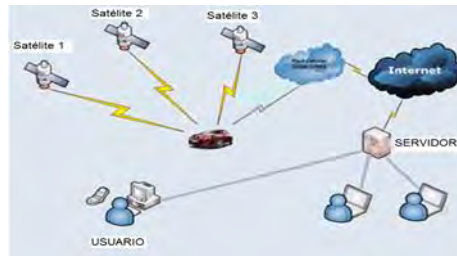
Figura 1. Composición de un sistema de rastreo satelital.
