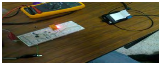
Figura 6. Prueba de activación de pulso del GPS y el circuito electrónico.
