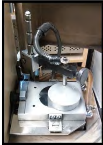
Figura 1.- Probeta en la cámara de combustión
