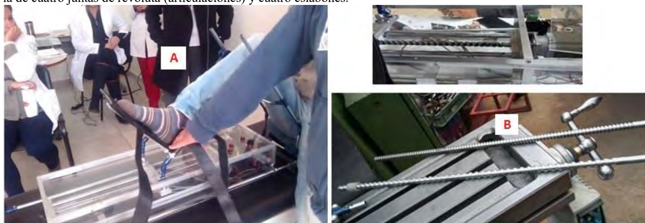
Figura 3 A) Reunión con terapeutas en pruebas iniciales del prototipo MRP, B) Modificación del tamaño de pazo del husillo acoplado al actuador eléctrico, se muestra el husillo anterior y el modificado (motor de pasos híbrido).
