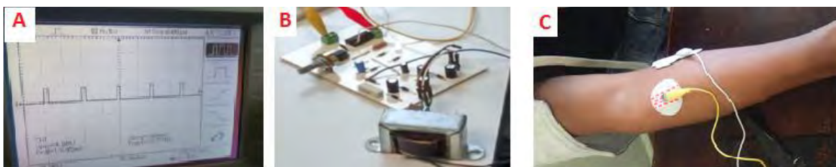
Figura 11 A) Señal PWM genera por el circuito de corriente galvánica para rehabilitación activa, B) Circuito impreso del generador de corriente galvánica (60V a 0-20mA), C) Prueba de aplicación en antebrazo.
