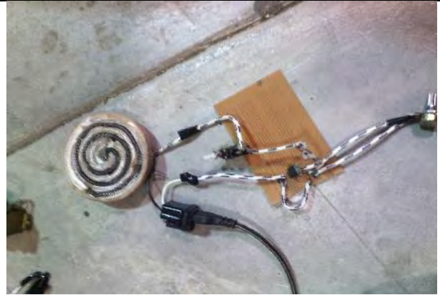
Figura 6. Placa de barro con tratamiento de Hidróxido de Calcio conectado al circuito Electrónico.
