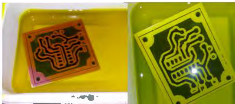
Fig. 9. Placa fenólica sumergida en cloruro férrico
