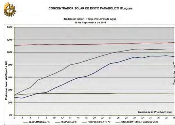
**Figura 5 Gráfica Radiación Solar, Temp. Agua, Temp. Recipiente, Temp. – Tiempo (min)**
