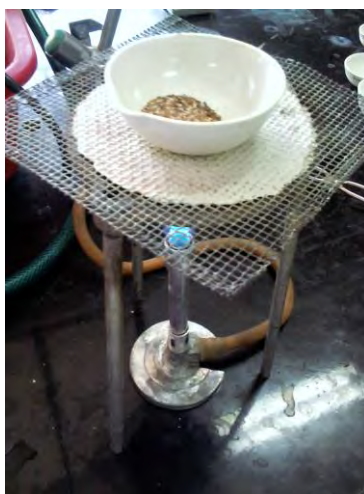
Fig. 4. Flameado de la muestra.
