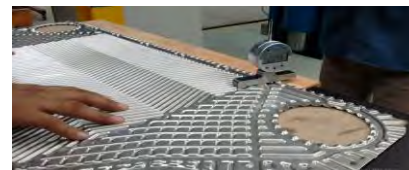
Fig. 6. Medición de profundidad.
