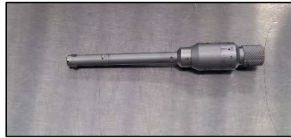
Figura 8: Instrumento (micrómetro graduado) para la medición de diámetros interiores.
