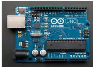
Figura 8: Placa de Arduino UNO.
