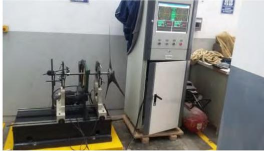
Figura 6. Vista del equipo de balanceo dinámico.
