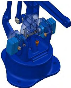
Figura 4: Posición de los servomotores en las articulaciones.
