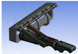
Figura 8. Malla utilizada para el cálculo de los esfuerzos y deformaciones del prototipo.
